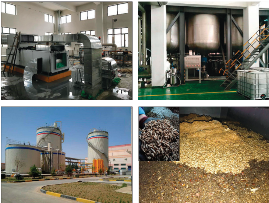
Ryc. 15. Zautomatyzowany zakład przetwarzania odpadów z łańcucha rolno -spożywczego na bazie hodowli Hermetia illucens (mucha czarna) w prefekturze Baotou (Chiny), gdzie jest utylizowane ponad 100 ton odpadów organicznych dziennie, wykorzystywanych do produkcji biogazu oraz białka owadów o masie około 1,3 tony dziennie
